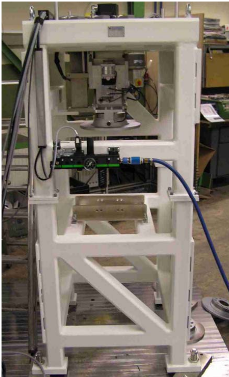
Maschinengestell von vorne (noch ohne Transportband)
